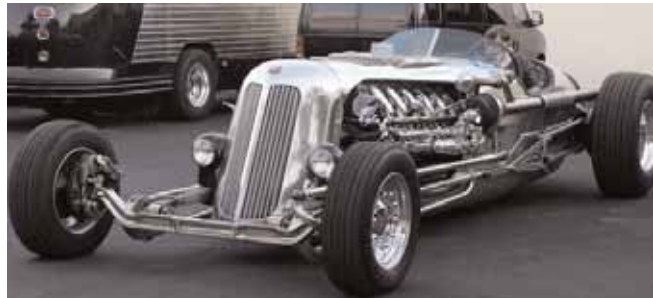
"The Tank Car", ein Show Auto mit einem M-47 Patton Panzer-Motor, 800 PS. Das zuerst eingebaute 4-Gang-Getriebe musste gegen ein verstärktes 6-Gang-Getriebe ausgetauscht werden
