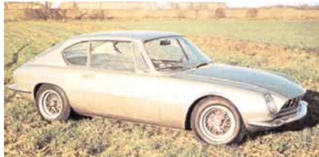
Innocenti 186 GT, 1964, Prototyp, gezeichnet vom jungen Giugiaro, welcher bei Bertone arbeitete. Motor von Ferrari V6, 1788 ccm, 158 PS.
