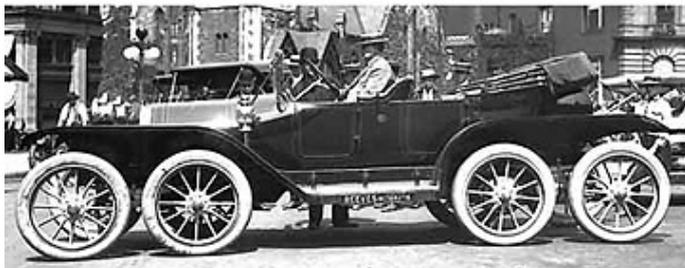
Pullmanwagen der US-Railway. Durch diese 4-Achs Konstruktion sollte das Oktoauto sanft über Schlaglöcher hinweg gleiten. Allerdings ließ sich das Gefährt sehr schwer lenken wegen der Achskonstruktion. Aus diesem Grund setzte sich diese Mehrachskonstruktion nicht durch. Auch als Reeves einen Dreiachsler (Sextauto) baute, blieb ihm der Erfolg versagt. Ebenso ging es anderen Konstrukteuren wie Lorraine-Dietrich, Borderail-Cail, Turcat-Mercy oder Broomell-Harding.
