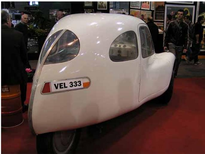
Angesichts einer Reisegeschwindigkeit von rund 60 km/h dürfte sich der konsequente Leichtbau weit mehr auf den Verbrauch ausgewirkt haben als die aerodynamischen Finessen. Spätere Messungen ergaben einen traumhaften CW-Wert von 0,282, den der VW-Lupo 1998 nur knapp verfehlte (0,30).
