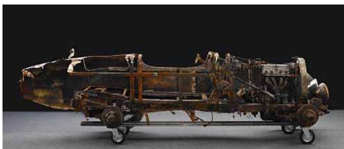
Die stark korrodierte rechte Seite des Typ 22
