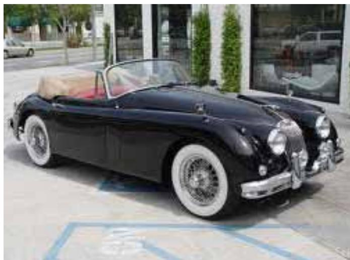
Die Modelle Jaguar XK 150 FHC (Fixed Head Coupé) und DHC (Drop Head Coupé) hatten, wie die Vorgänger, einen Sechszylinder-Reihenmotor mit 3442 cm<sup>3</sup> Hubraum und 193 oder 213 PS. Über ein Viergang-Getriebe, Overdrive als Op-
