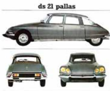
André Lefèbvre galt als Liebhaber neuer Materialien und war ein Verfechter des Einsatzes von Kunststoff und Aluminium zur Gewichtsreduzierung. So besteht beispielsweise das Dach der DS aus GFK. Es wurden 100 Kilogramm Aluminium verbaut (wie bei der Motorhaube, dem größten damals in Serie gefertigten Aluminium-Karosserieteil) und verchromter Stahl an Stoßstangen und Zierleisten durch Edelstahl ersetzt.
