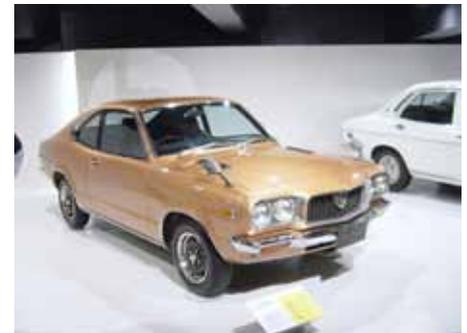
Der RX-3 ist der erste Mazda mit Wankelmotor, der nach Deutschland exportiert wird. Der Hecktriebler mit hinterer Starrachse ist gerade mal vier Meter lang und wird vom 10A Wankel angetrieben. Der bringt es mit zweimal 491 ccm Kammervolumen auf eine Leistung von 105 PS bei 7.000 U/min und ein maximales Drehmoment von 134 Nm bei 3.500 U/min.
