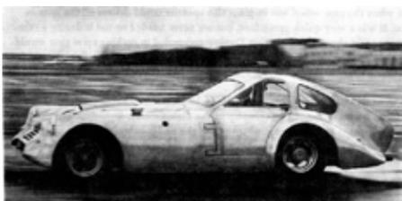
wurden. Das Gesamtkonzept war darauf angelegt, das Gewicht des Wagens so weit wie möglich zwischen den Achsen zu positionieren. Der Tank wurde daher zwischen dem in Front-Mittelmotor-Lage untergebrachten Motor und der knappen Fahrerkabine angeordnet.
