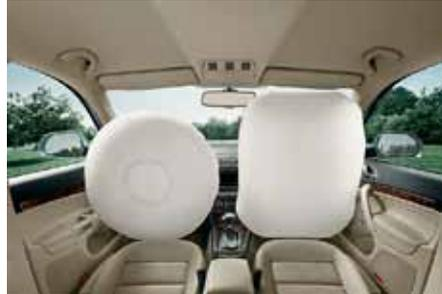
die Mitte der 1960er-Jahre begonnen hat. Wenn Sensoren eine Kollision feststellen, wird eine Treibladung gezündet, und der dabei entstehende Stickstoff bläht in wenigen Millisekunden einen Sack aus Spezialgewebe auf. Das so entstehende Kissen schützt den Menschen vor dem Aufprall auf dem Armaturenbrett.
