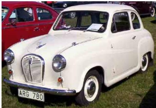
noch ein 2-türiger Pickup angeboten. Die Unterschiede zum Modell A30 waren ein größeres Heckfenster, eine Blinkanlage statt der Winker sowie ein größerer Motor. Sein Hubraum betrug 948 cm<sup>3</sup>, seine Leistung 34 bhp (25 kW). Die Limousine erreichte damit 117 km/h.
