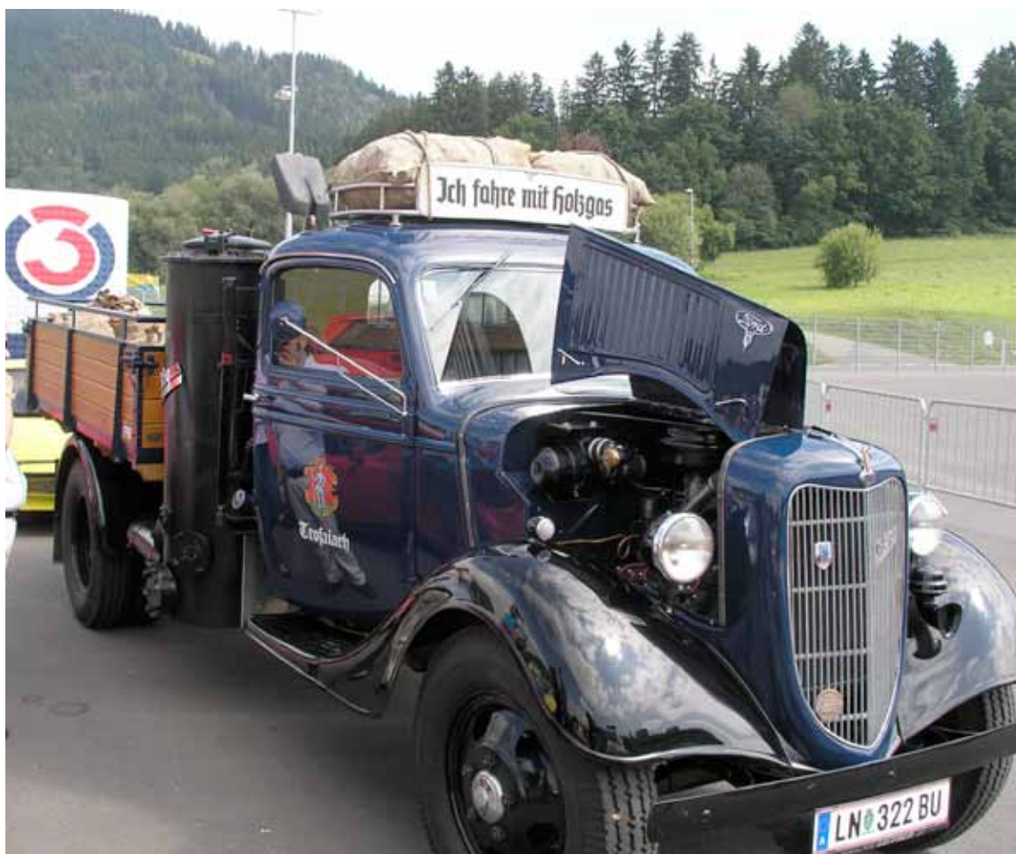
Ford Lieferwagen der End 30er Jahre mit Holzvergassungs Anlage. Gesehen am Red Bull Ring. Foto: Herbert Fischer
