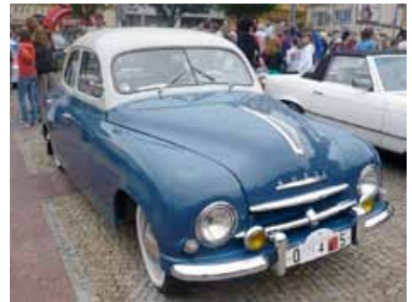
Škoda 1200, das erste Serienfahrzeug von Škoda mit selbsttragender Vollstahl-Karosserie
