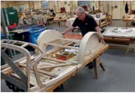
Eschenholz-Rahmen im Morgan Werk Fotos: Morgan Motors
