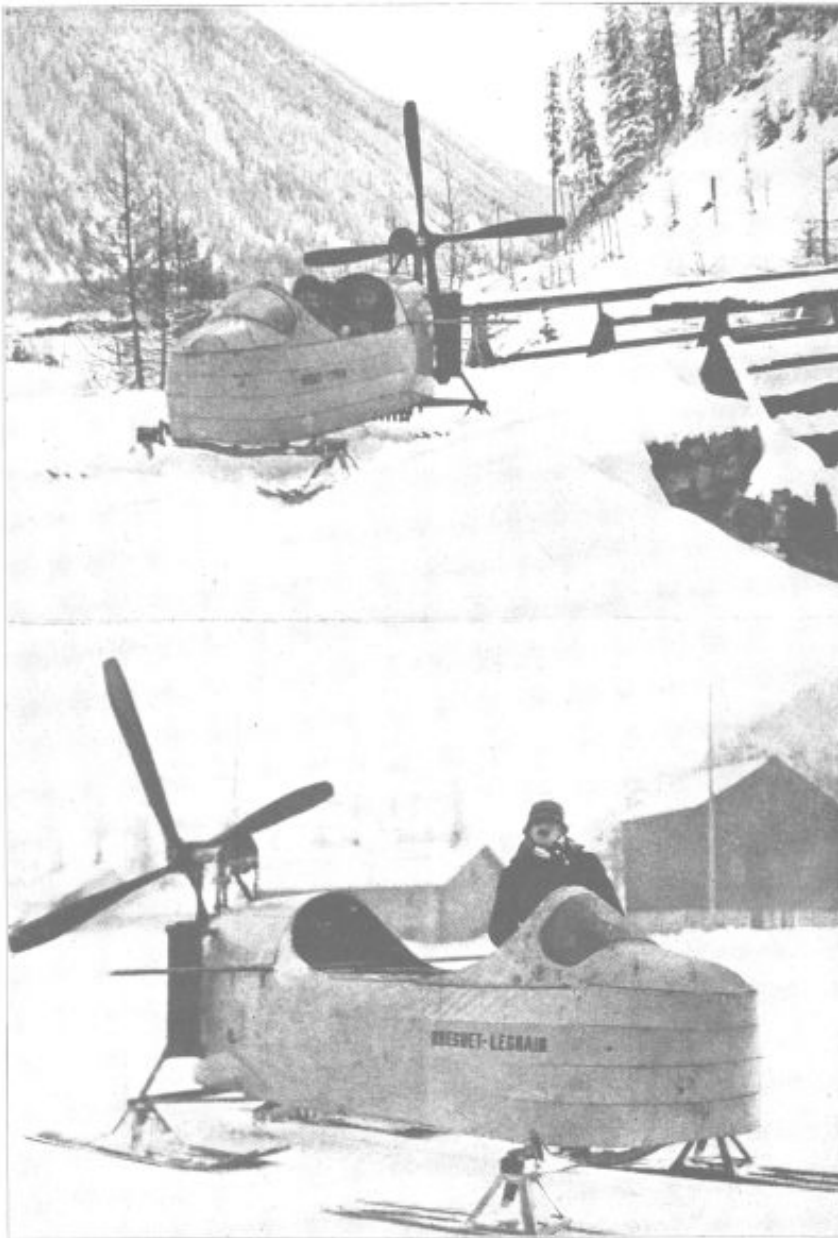
Der Motorchlitten Legrain-Breguet mit Luftschraubenantrieb (Jänner 1913).
