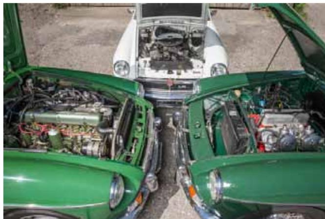
MGB GT V8 (1974) - drei Motorvarianten, rechts der Vierzylinder, links der Sechszylinder im MGC und hinten der V8 im MGB GT V8
