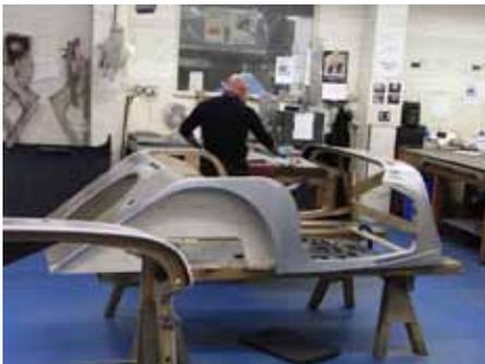
Der auf dem Rahmen aufgesetzte Aufbau besteht aus einem Gerippe aus Eschenholz, je nach Modell und Baujahr mit Stahl- oder Alublech beplankt.
