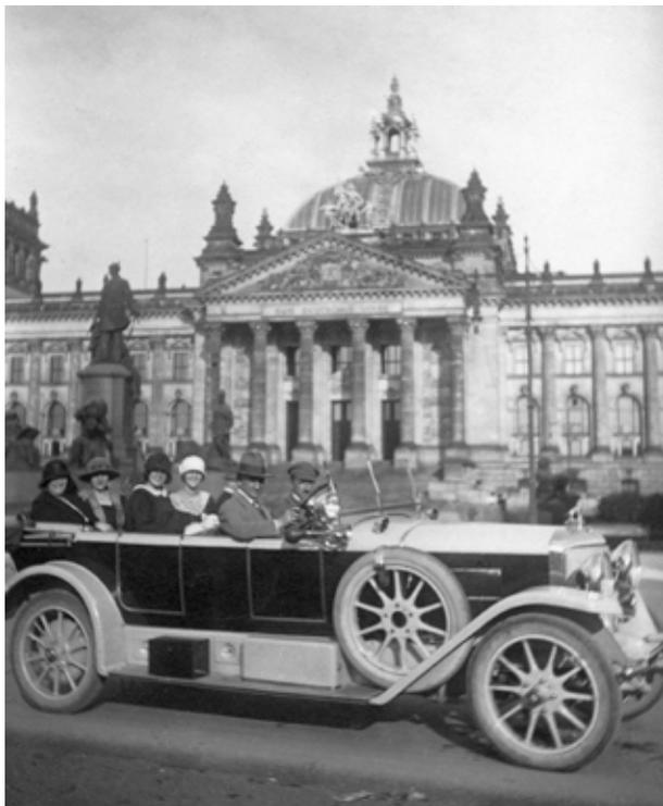
Typisch für die Wagen von Gräf & Stift der frühen 1920er Jahre waren auch die in zwei übereinanderliegenden Reihen angeordneten Luftschlitze in der Motorhaube.
