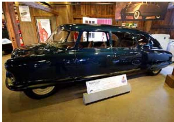
Die kurze, stromlinienförmige Nase und der sich nach hinten verjüngende Aufbau nahmen das „One-Box-Design“ moderner Minivans vorweg. Die Sitze der zweiten Sitzreihe ließen sich nach hinten drehen und es gab abnehmbare Tische.
