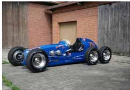
1948 erreichte der Rennbolide mit Billy de Vore am Steuer den 12. Platz, 10 Runden hinter dem Ersten. 1949 mit dem Piloten Jackie Holmes schied der Wagen im letzten Drittel des Rennens mit gebrochener Hinterachse aus. Das Konzept scheiterte vor allem an den 100 Kg Mehrgewicht welches auch mit Magnesiumräder nicht nennenswert verbessert wurde.
