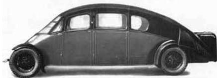
Das Chassis der viertürigen Limousine besaß einen Radstand von 3.785 mm. Der Innenraum mit 7 Sitzplätzen war komplett zwischen den beiden Achsen untergebracht und der Motor saß hinter der Hinterachse. Das Reserverad war an einer hinteren Tür innen angebracht; an der gegenüberliegenden Tür hing entweder ein zweites Reserverad oder eine Bar.
