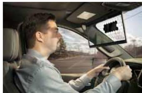
Auch wenn herkömmliche Sonnenblenden Autofahrer vor störendem Gegenlicht schützen, versperren sie – einmal heruntergeklappt – oft auch große Teile des Sichtfeldes. Mit der neuen transparenten und digitalen Sonnenblende, dem Virtual Visor, erfindet Bosch den „Oldie“ neu und revolutioniert damit den Fahrzeuginnenraum. Die klassische Sonnenblende wird dafür durch ein transparentes LCD-Display und eine auf den Fahrer ausgerichtete Kamera ersetzt. Dank intelligenter
