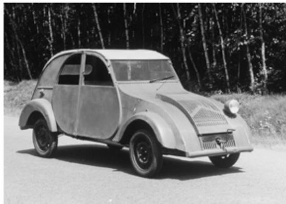
Konzeptionell war der TPV durch weitgehende Verwendung von Leichtmetall vorrangig auf Gewichtsreduktion ausgelegt. Das Leergewicht betrug anfangs nur 380 Kilogramm, dank des Aufbaus aus Aluminium konnte auf eine Lackierung verzichtet werden.
