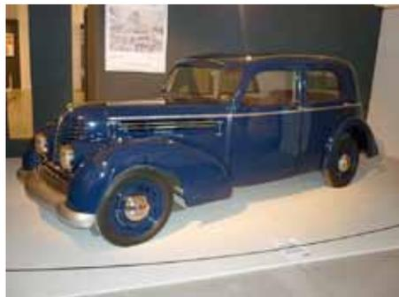
einen DKW-Ingenieur angeworben, zunächst kam ein Zweizylindermotor mit 750 cm<sup>3</sup> Hubraum zum Einsatz, später ein Dreizylindermotor mit 1034 cm<sup>3</sup> Hubraum, der 34 PS leistete. Es gab die Karosserieformen Cabriolet, Kombi und viertürige Limousine, die oftmals als Taxi
