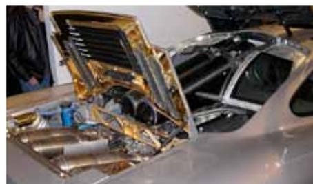
Beim Blick in den Motorraum ist die wärmereflektierende Beschichtung aus Gold gut zu erkennen, die die Karosserie aus CFK schützt.
