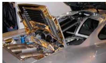
Beim Blick in den Motorraum ist die wärmereflektierende Beschichtung aus Gold gut zu erkennen, die die Karosserie aus CFK schützt.
