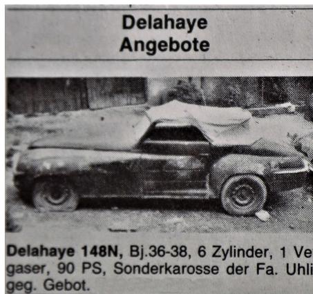
Delahaye 148N, Bj.36-38, 6 Zylinder, 1 Ver-gaser, 90 PS, Sonderkarosserie der Fa. Uhlig geg. Gebot.
