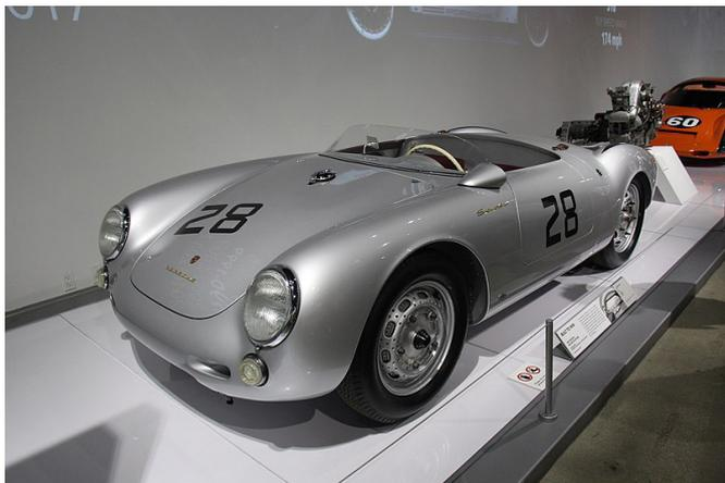
550 Kilogramm setzte sich aus dem aus Rohren verschweißten Flachrahmen, Karosserieblechen und einem Motor zusammen. (Erst der Nachfolger 550 A erhielt übrigens einen steiferen Gitterrohrrahmen.) Das Auto hatte vier Gänge, ein Sperrdifferential und Einzelradaufhängung. Laut Porsche war das Fahrzeuggewicht übrigens nicht der Grund, den Neuen 550 Spyder zu nennen. Vielmehr war der Wagen wohl die 550. Porsche-Konstruktion. Und Quell für mannigfaltige Legenden.
