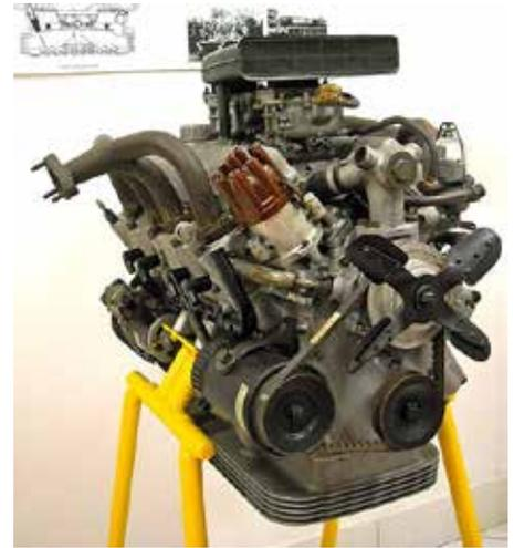
waren 1,3-Liter-Motoren vorgesehen. Dante Giacosa, zu diesem Zeitpunkt Leiter der Entwicklungsabteilung für Motoren bei Fiat, entwickelte nach klassischem Vorbild den Motor mit einer Bohrung (72 mm) die kleiner als der Hub (78 mm) war. Als der 101E1 mit dem Motor 1946 er-
