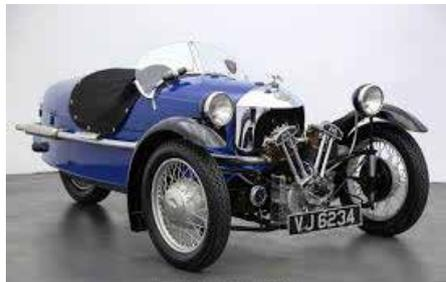
Form – wie in einem Pkw-Fahrwerk vertikal geführt; der Wagen neigt sich in Kurven etwas nach außen. Das Fahrzeug war wenig mehr als drei Meter lang und etwa 1,50 Meter breit.
